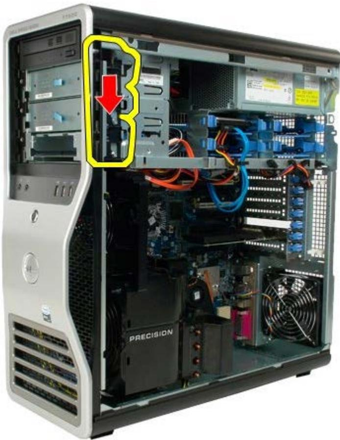
5. Deslice la unidad óptica fuera de la parte frontal del chasis y extráigala del equipo.
