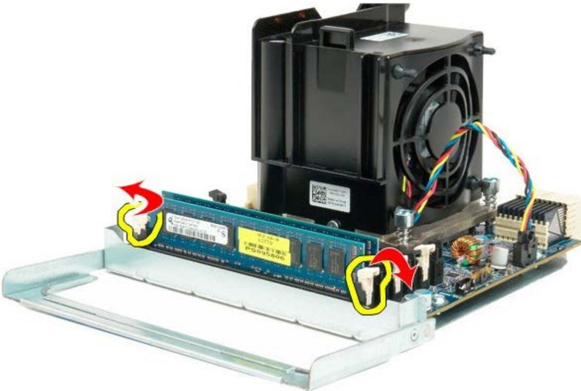
10. Retire el primer módulo de memoria de la placa del procesador doble y repita la operación con los demás módulos de memoria.
