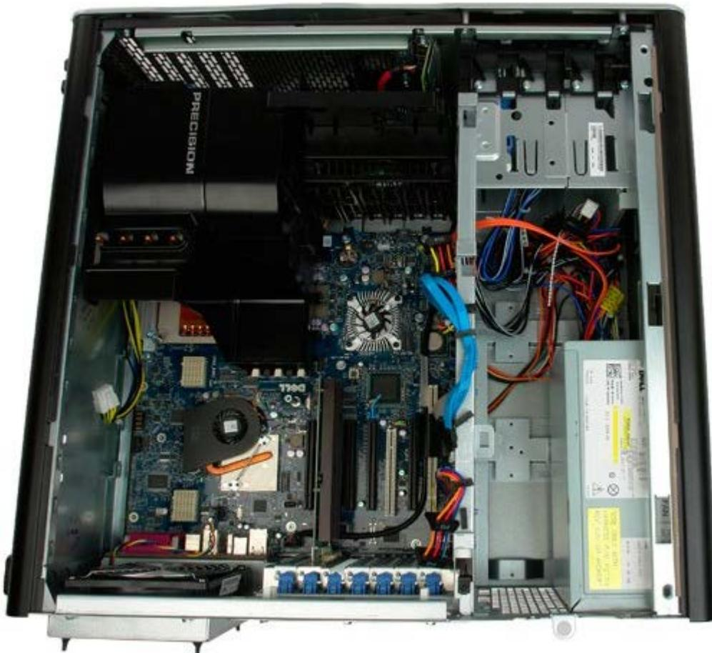
4. Desconecte el cable de la parte posterior de la fuente de alimentación.
