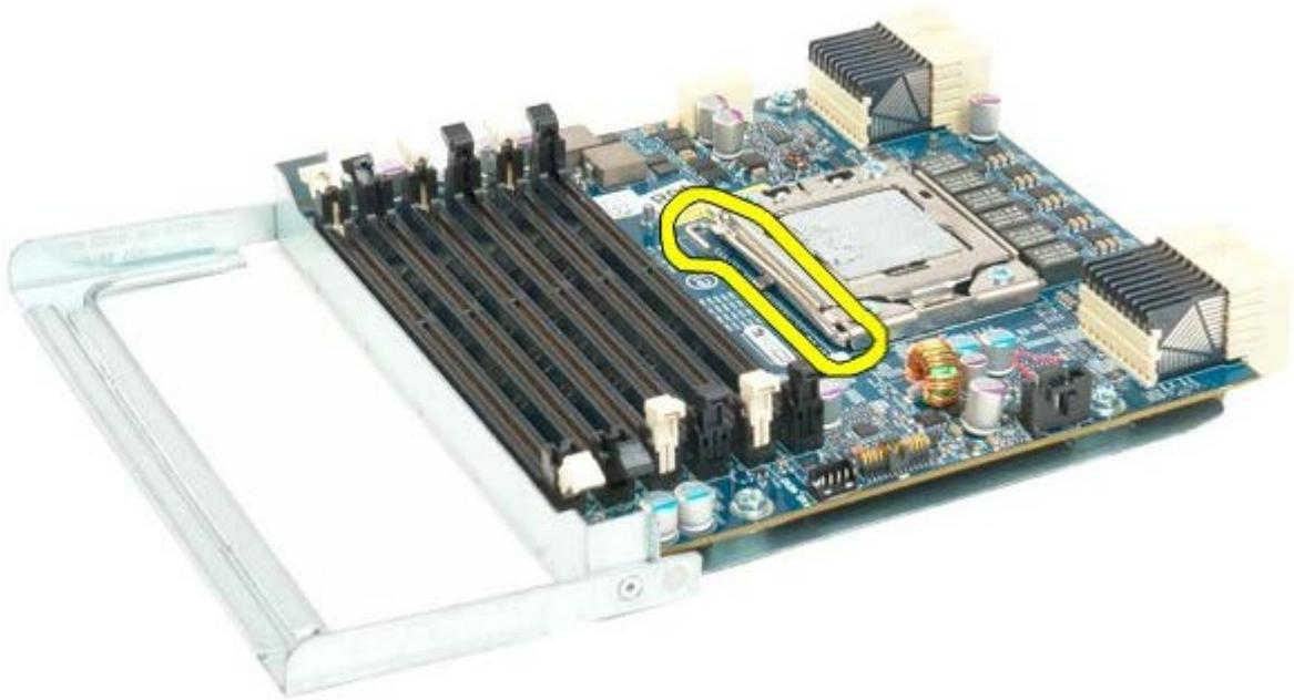
15. Abra la cubierta del procesador doble.
