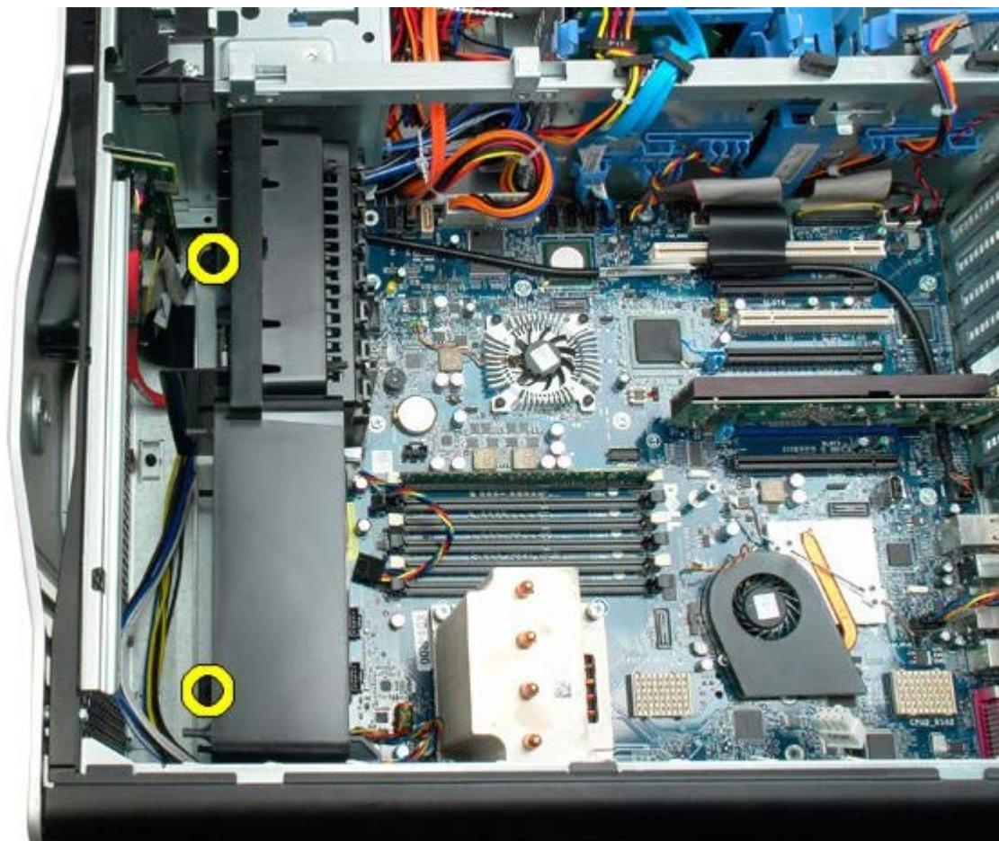
6. Gire el ensamblaje del ventilador hacia el centro del equipo.
