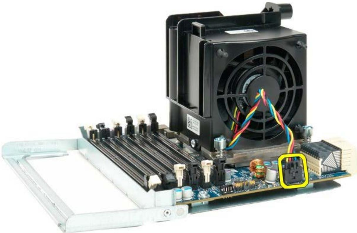
12. Afloje los cuatro tornillos cautivos del conjunto de ventilador/disipador de calor del procesador doble.
