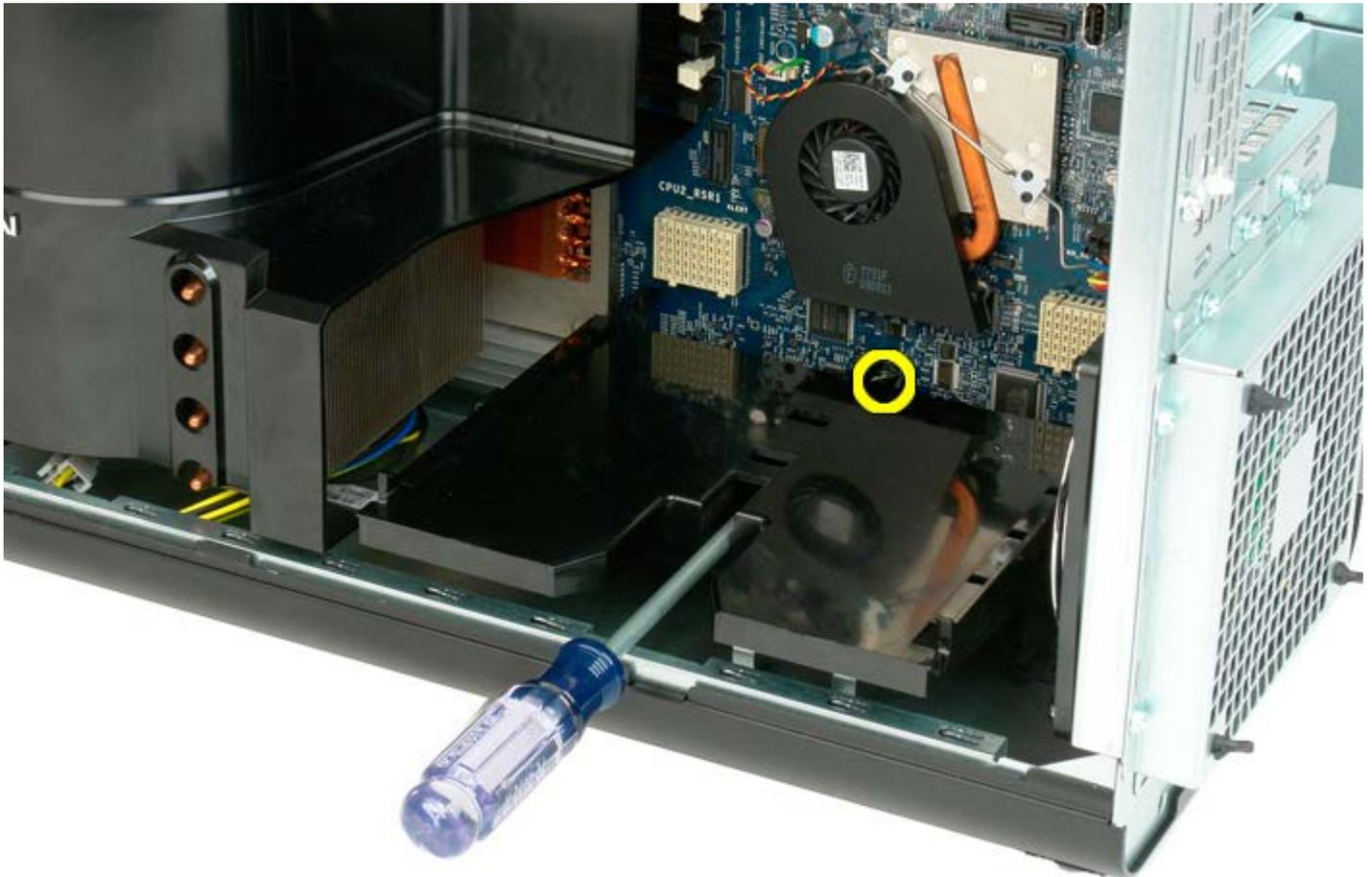
4. Retire el segundo tornillo utilizando el destornillador Phillips.
