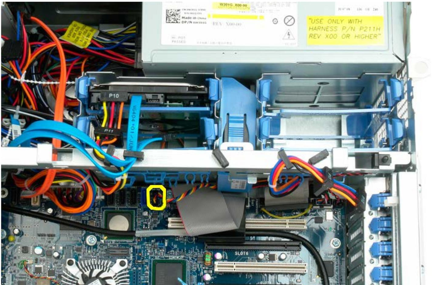
4. Desconecte el cable sata para permitir que el ventilador de la unidad de disco duro se deslice.
