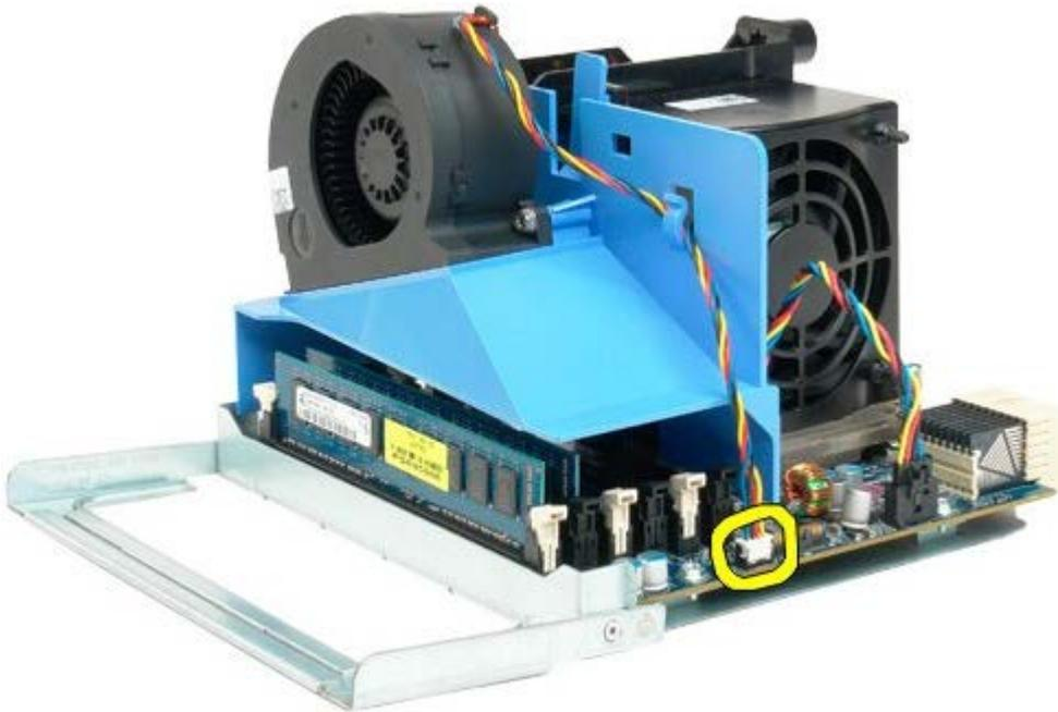
8. Mientras presiona la lengüeta de liberación azul, retire el ensamblaje del ventilador del procesador doble.
