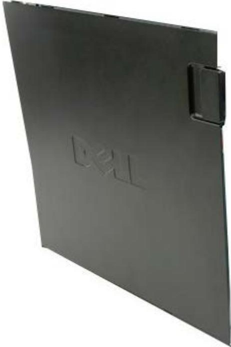
2. Deslice el pestillo de liberación de la cubierta hacia la parte posterior del equipo.
