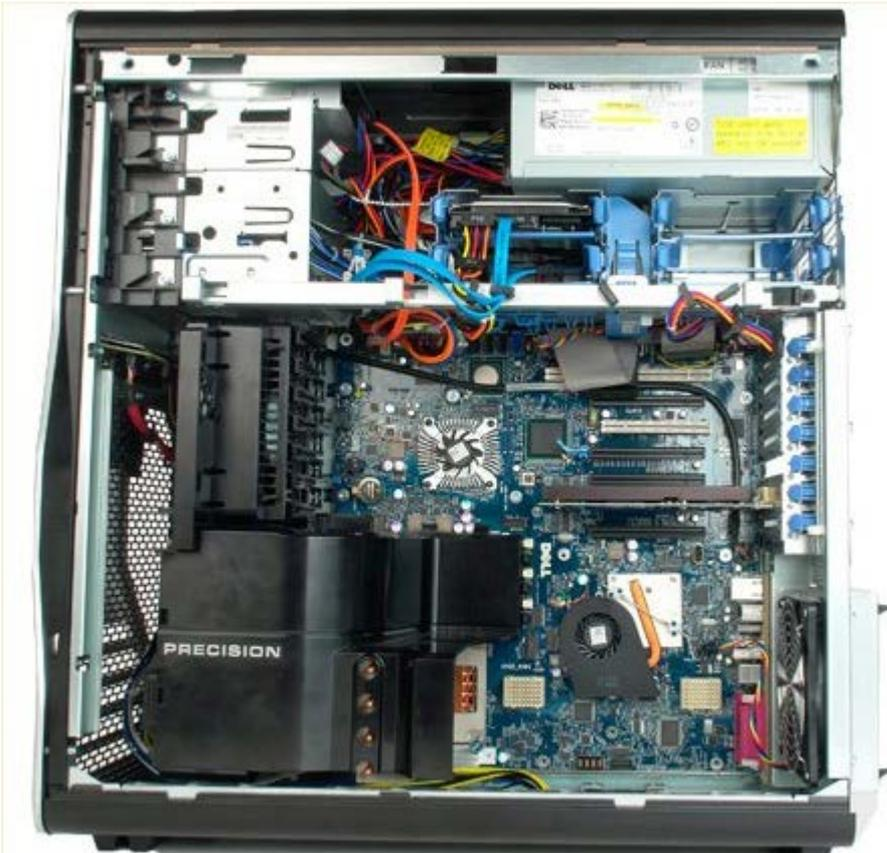
3. Desconecte el cable del ventilador de la unidad de disco duro de la placa base.
