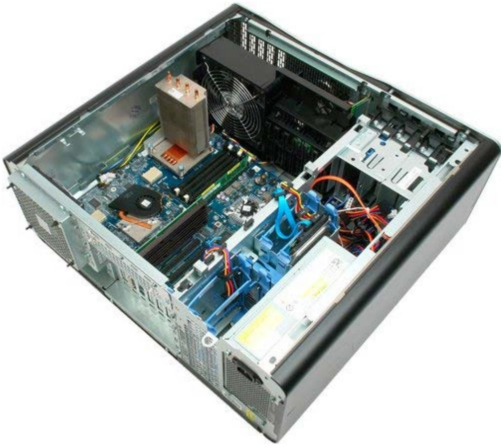
4. Desconecte el cable del ventilador del procesador de la placa base.
