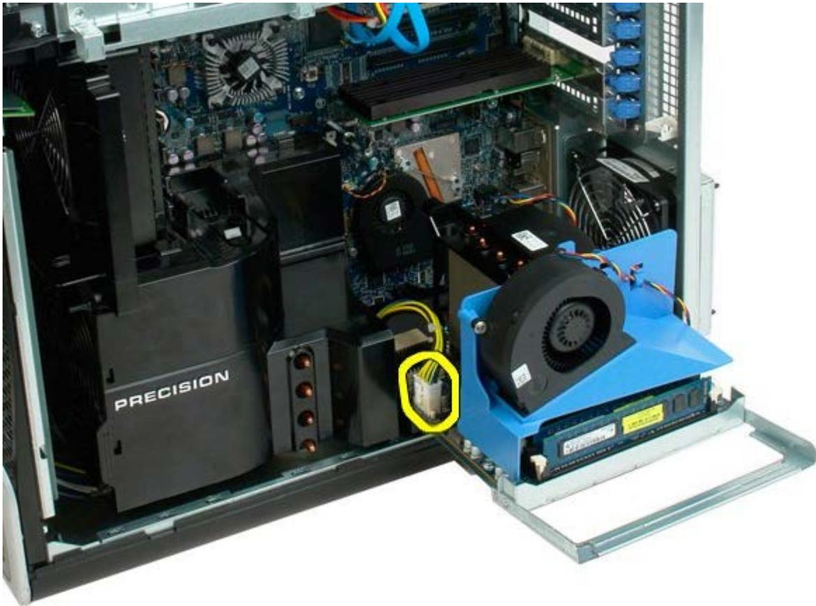
6. Retire completamente la tarjeta vertical del procesador doble del chasis del equipo.
