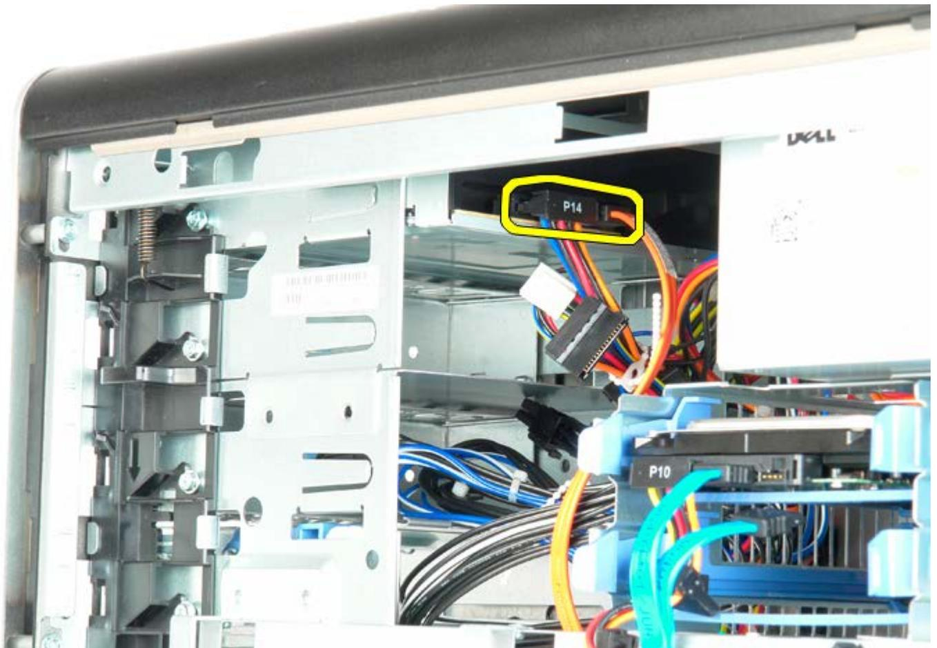
4. Presione la palanca de la placa deslizante y manténgala presionada.
