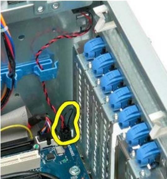
4. Retire el cable del interruptor de intrusión del gancho de sujeción.
