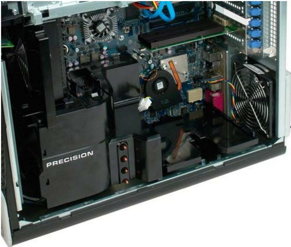
7. Desconecte el cable del ventilador del procesador doble de la placa del procesador doble.
