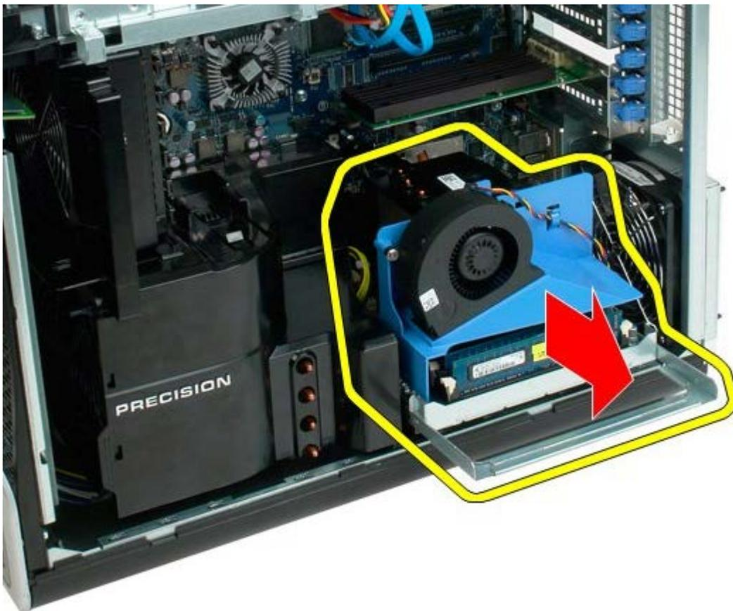
5. Desconecte el cable de alimentación de la placa del procesador doble.
