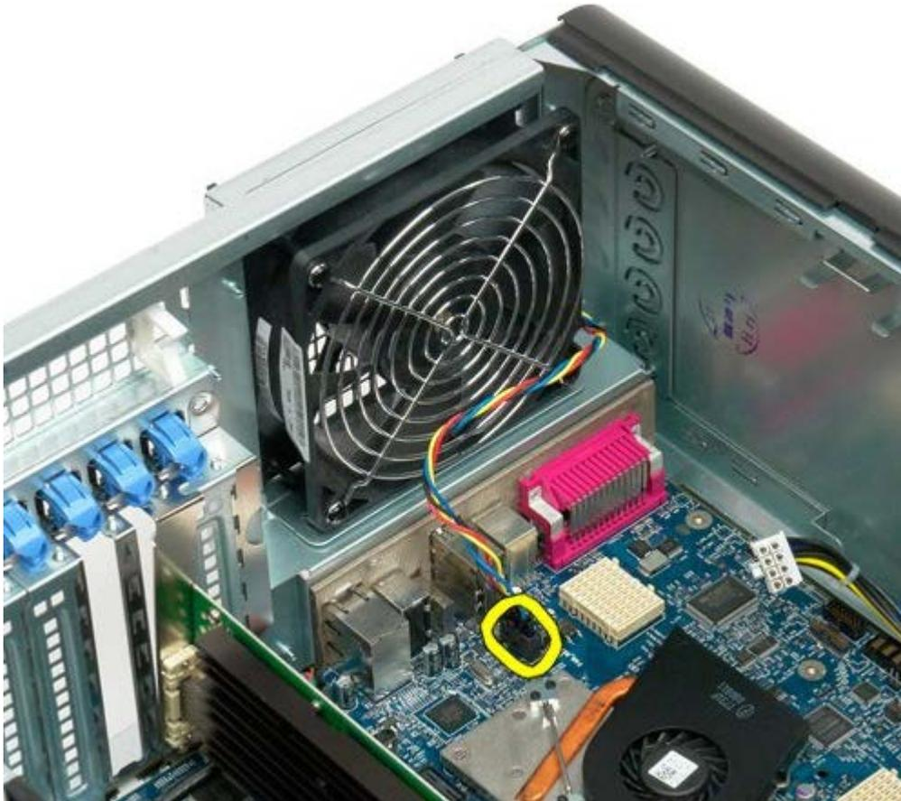
4. Desde el exterior del equipo, tire de cada uno de los cuatro soportes de goma negra para desconectar el ventilador del equipo.
