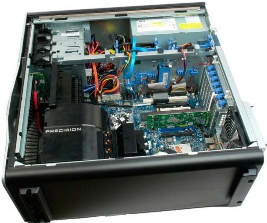
3. Levante el gancho de retención de la tarjeta de expansión para extraerlo del chasis.
