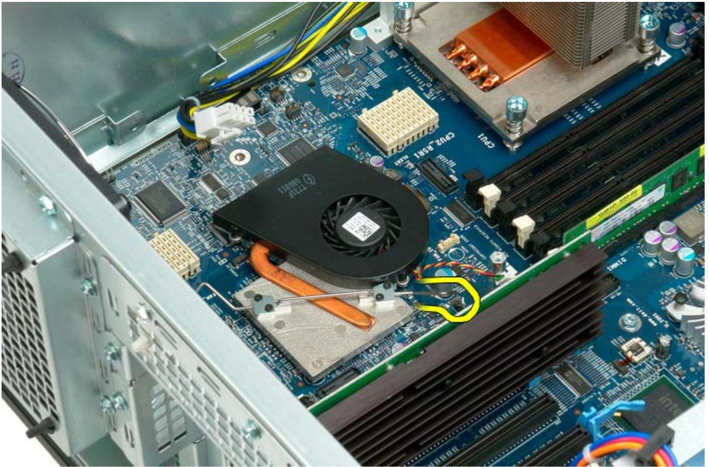
6. Retire el ventilador del conjunto de chips del equipo.
