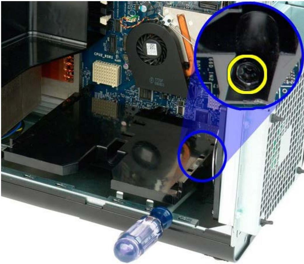
5. Retire el último tornillo que fija la guía de la tarjeta vertical al equipo.
