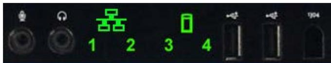
En el panel de control frontal se han incorporado cuatro (4) indicadores luminosos de un solo color que pueden servir de diagnóstico para solucionar los problemas de los sistemas que muestran síntomas de una situación sin vídeo ni autoprueba de encendido. Los indicadores luminosos NO notifican errores de tiempo de ejecución.
