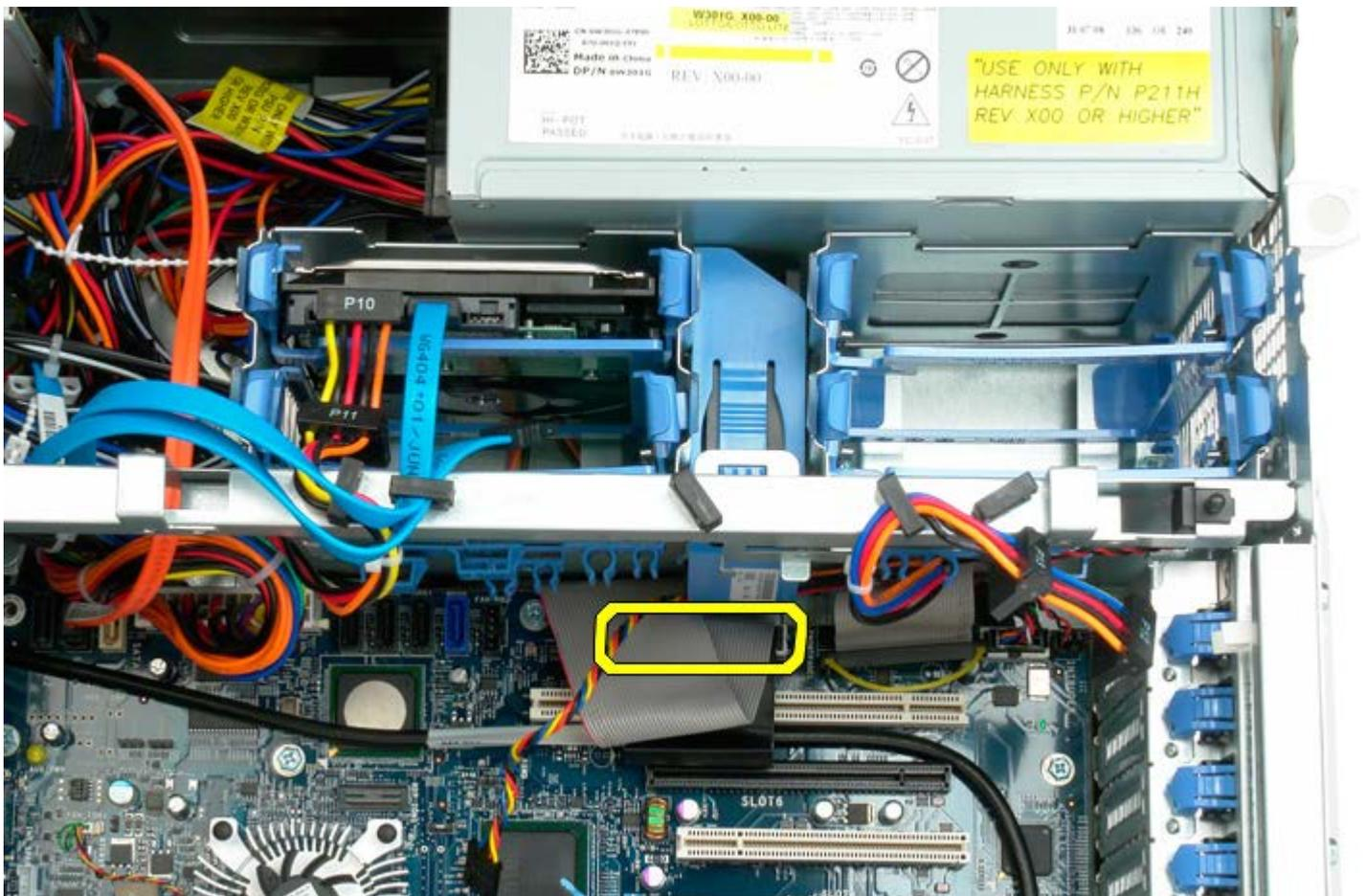
5. Presione la lengüeta de liberación del ventilador y deslice el ventilador de la unidad de disco duro hacia la placa base; a continuación, extraiga el ventilador de la unidad de disco duro del equipo.
