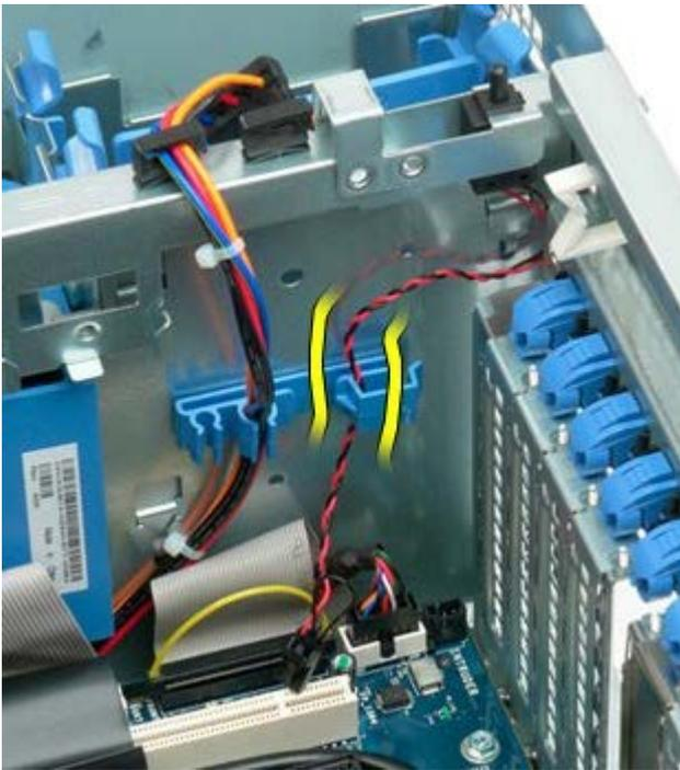
5. Deslice el interruptor de intrusión hacia el centro del equipo.
