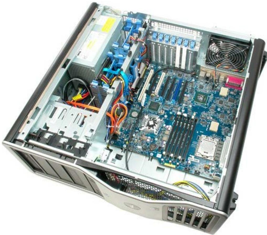
8. Desconecte el cable del ventilador posterior.
