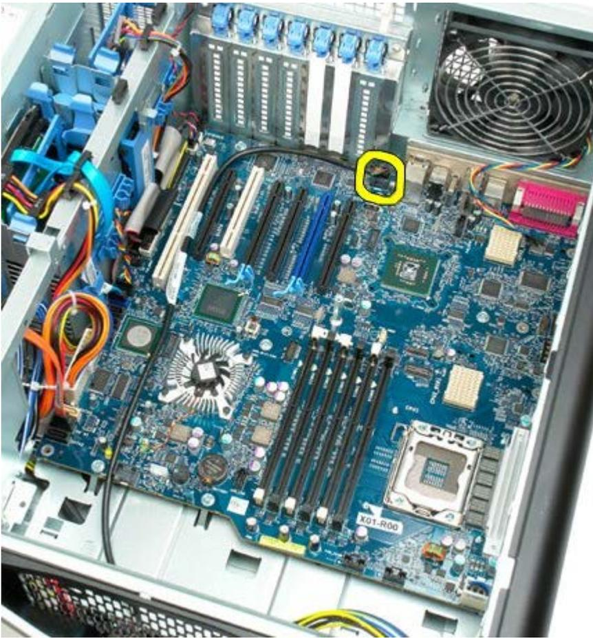
10. Desconecte el cable del interruptor de intrusión.
