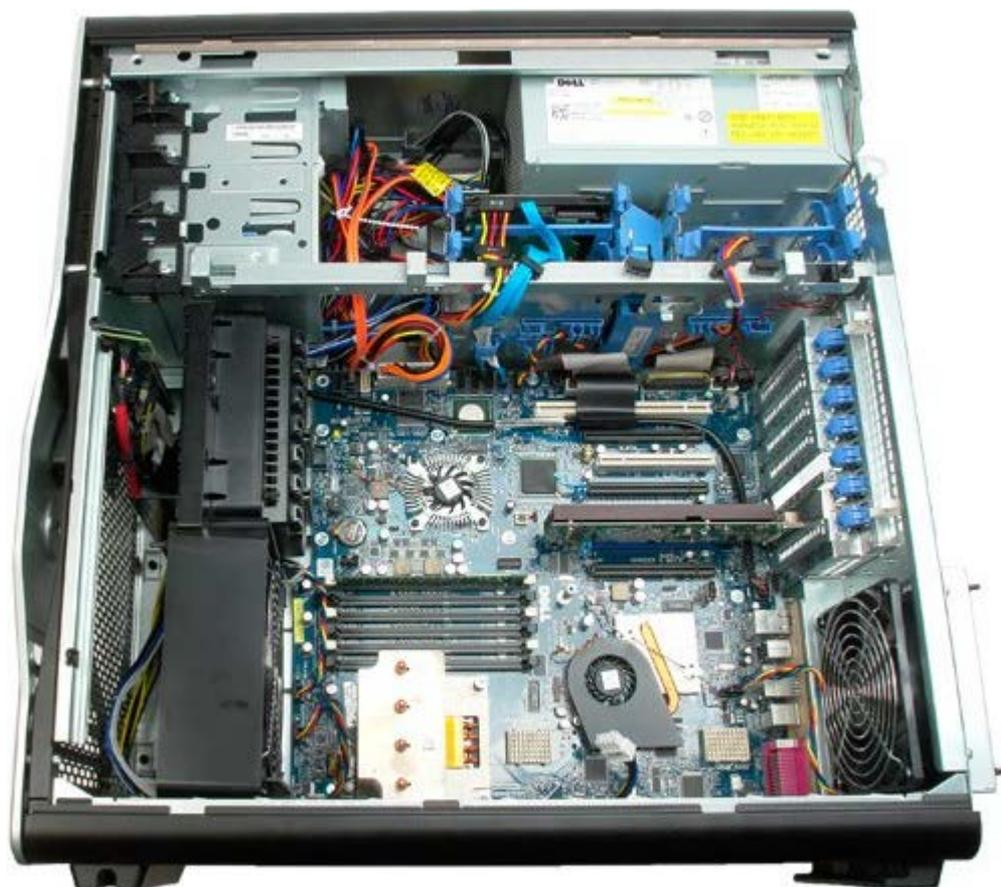
4. Desconecte los dos cables del ventilador de la placa base.
