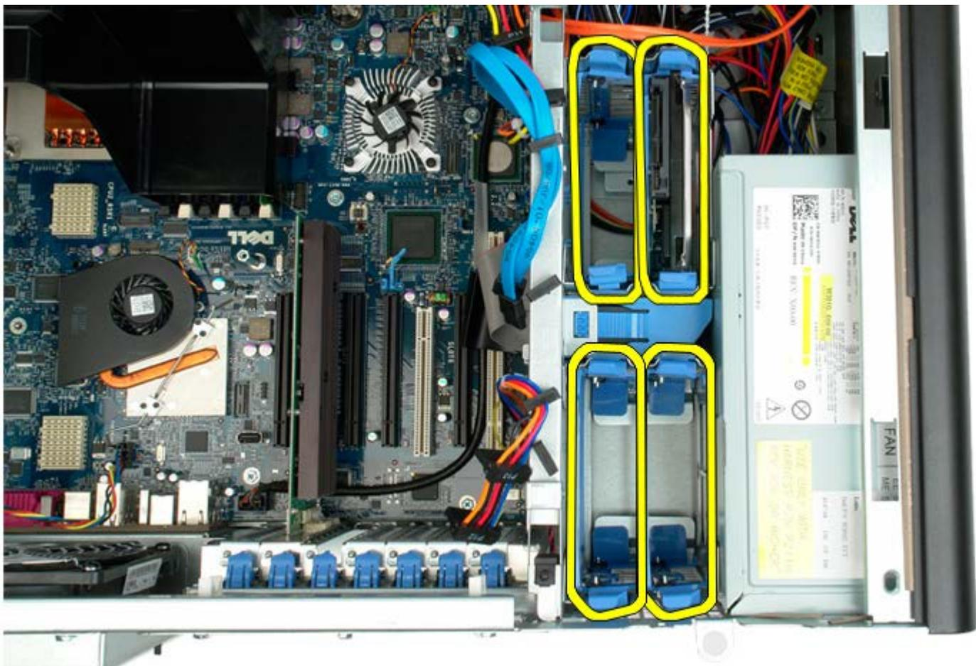
4. Extraiga los tornillos que fijan la caja de la primera unidad de disco duro al chasis.
