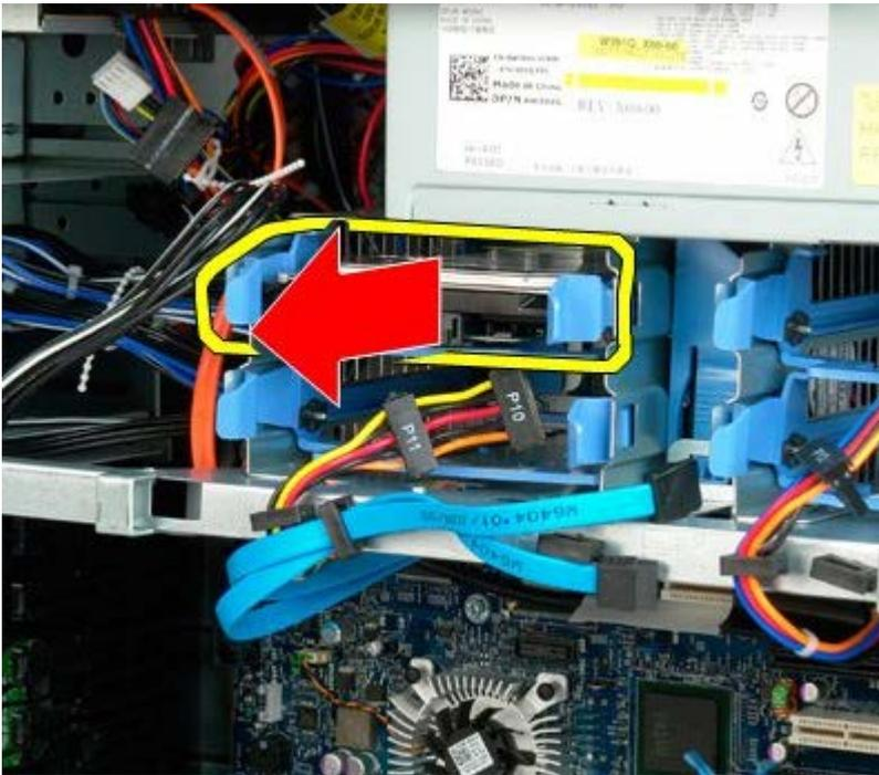
6. Retire el ensamblaje de la primera unidad de disco duro del equipo y repita la operación con cualquier otro disco duro que haya instalado.
