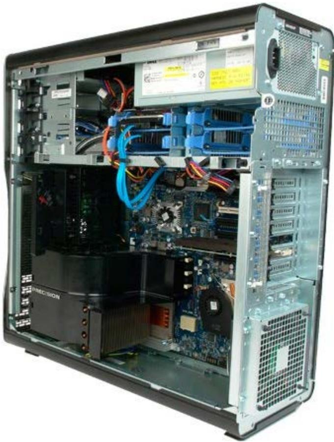
3. Desconecte el cable de datos y el de alimentación de la parte posterior de la unidad óptica.
