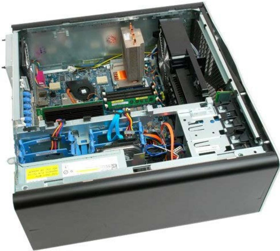
4. Afloje los cuatro tornillos cautivos del disipador de calor.
