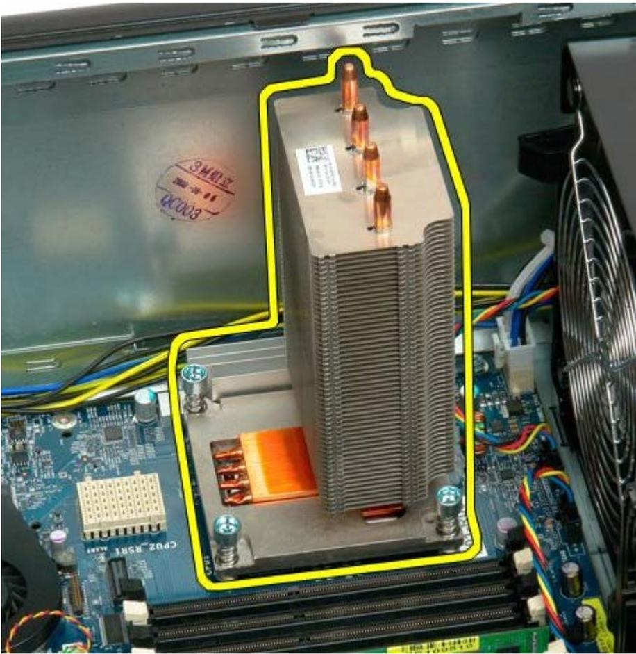
6. Presione hacia abajo y hacia fuera el brazo del compartimento del procesador para soltarlo.
