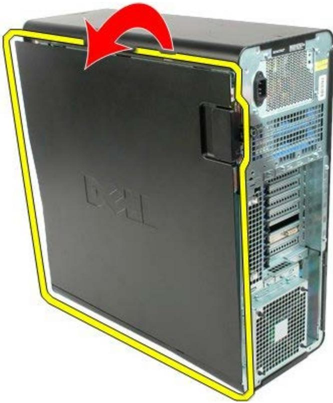
4. Retire la cubierta del equipo.
