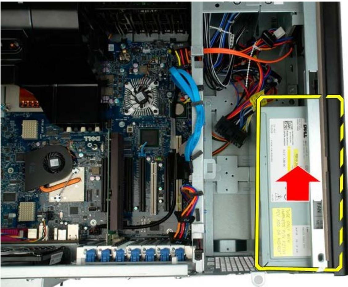
7. Retire la fuente de alimentación del equipo en posición inclinada.
