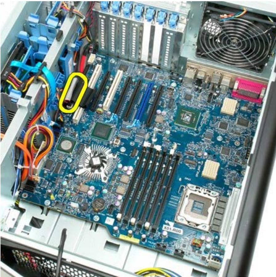
14. Desconecte el cable del ventilador del disco duro.
