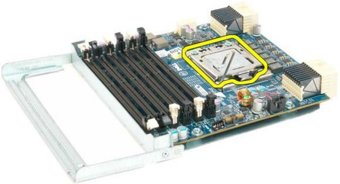
16. Retire el procesador doble de la placa del procesador doble.
