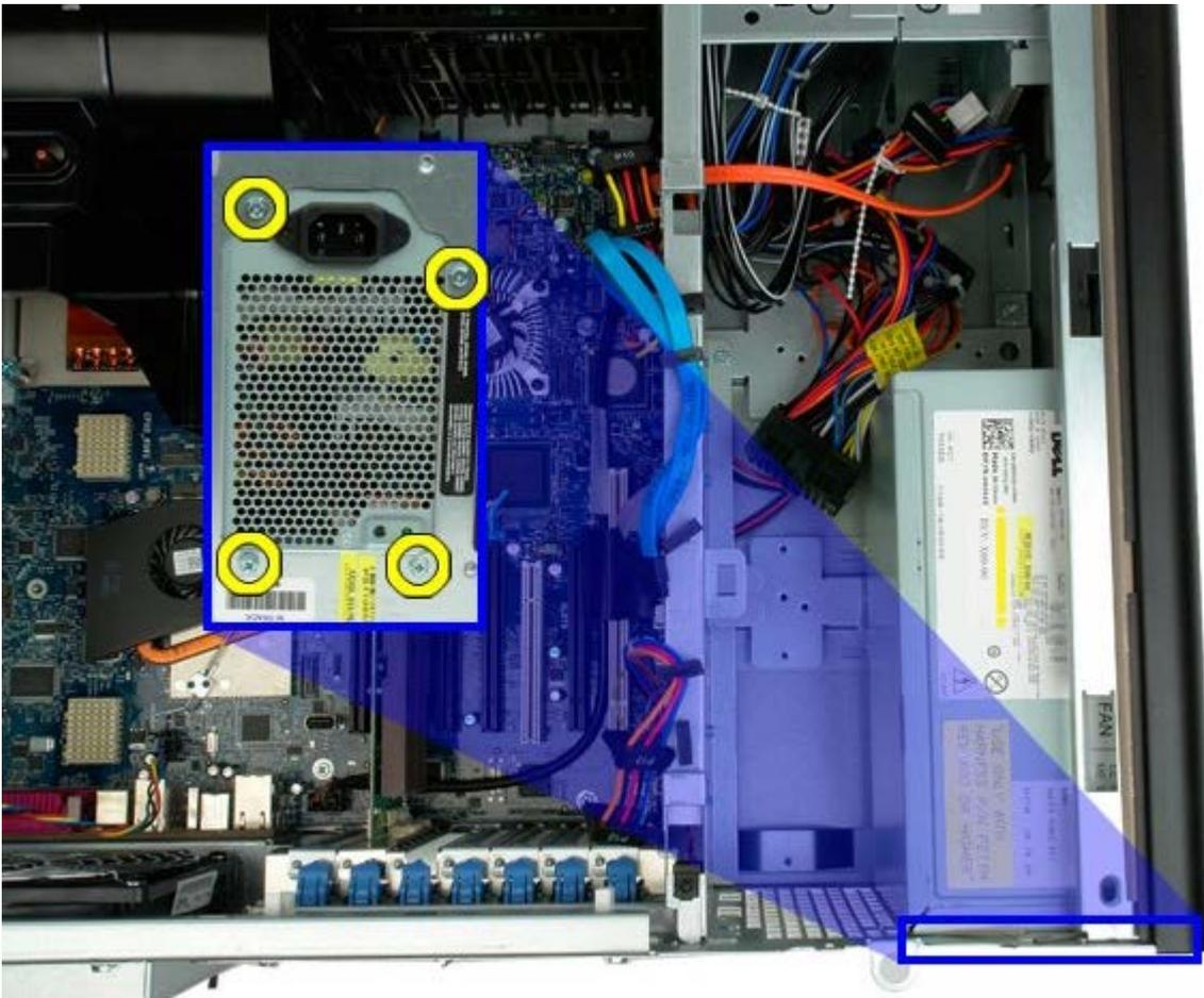
6. Deslice la fuente de alimentación hacia la parte interior del equipo.
