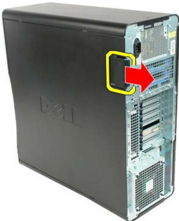
3. Levante la cubierta del equipo.
