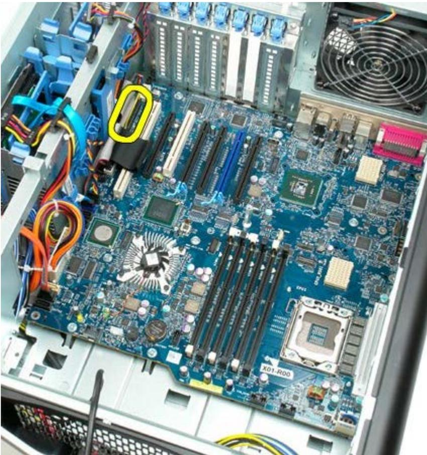
13. Desconecte el cable del panel de E/S.
