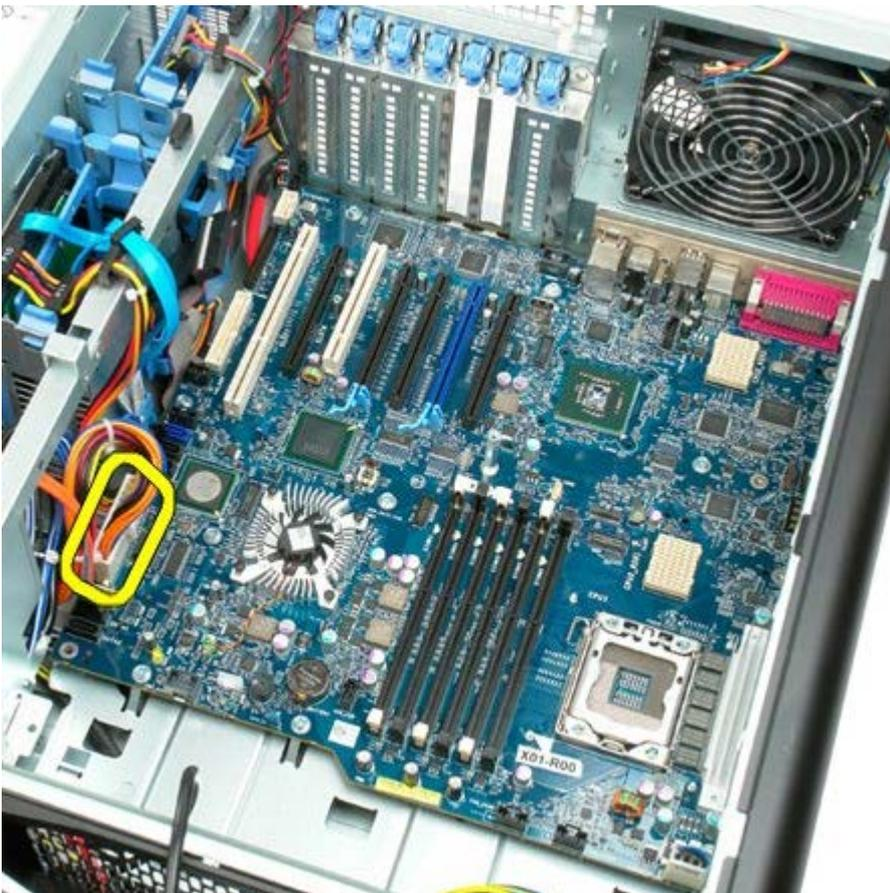
17. Desconecte el cable de datos de la unidad óptica.
