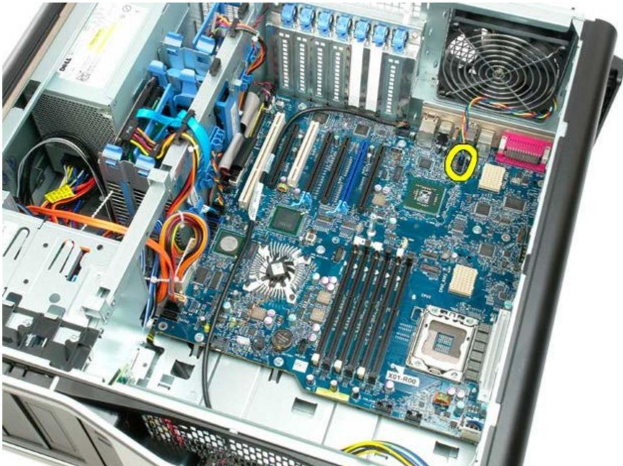
9. Desconecte el cable de audio del panel frontal.
