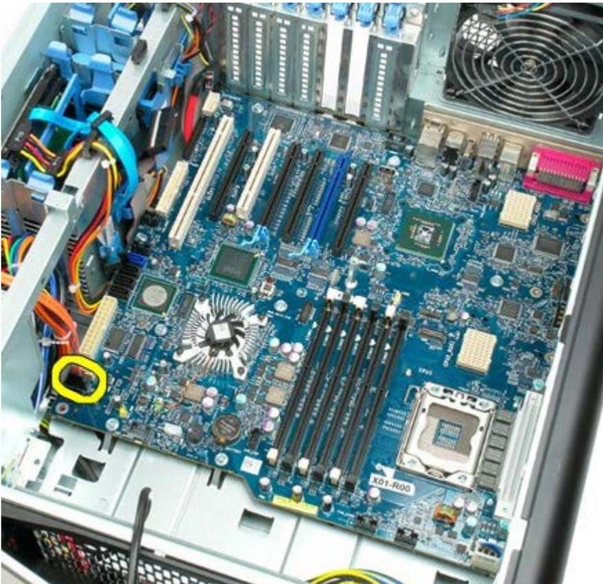
18. Desconecte el cable de datos de la fuente de alimentación.
