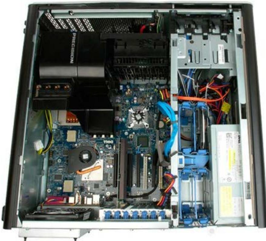
3. Extraiga cualquier unidad de disco duro instalada y sus guías.
