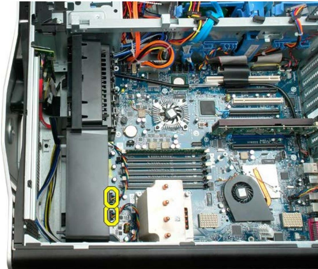
5. Retire los dos tornillos que fijan el ensamblaje del ventilador frontal.
