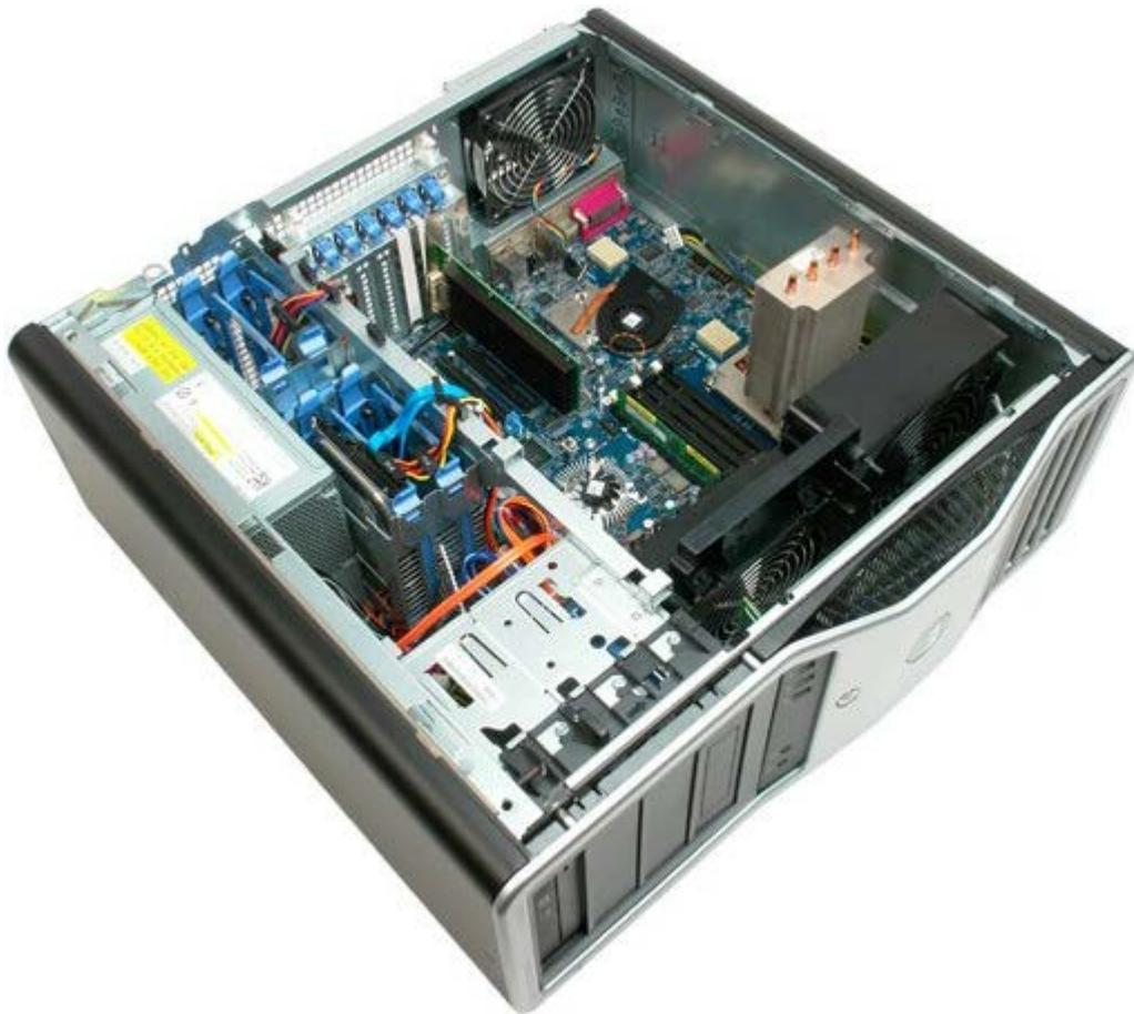
3. Desconecte el cable del ventilador del módulo de memoria posterior de la placa base.
