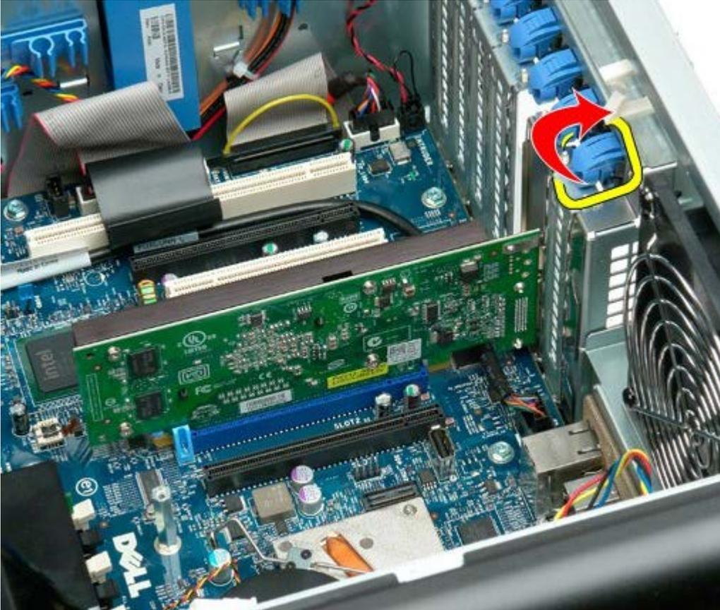
4. Deslice hacia atrás el gancho y retire la tarjeta de expansión.
