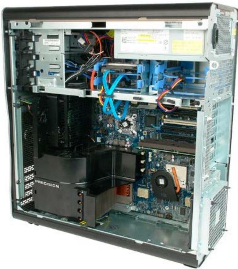
3. Desconecte el cable de datos y el cable de alimentación de la primera unidad de disco duro.
