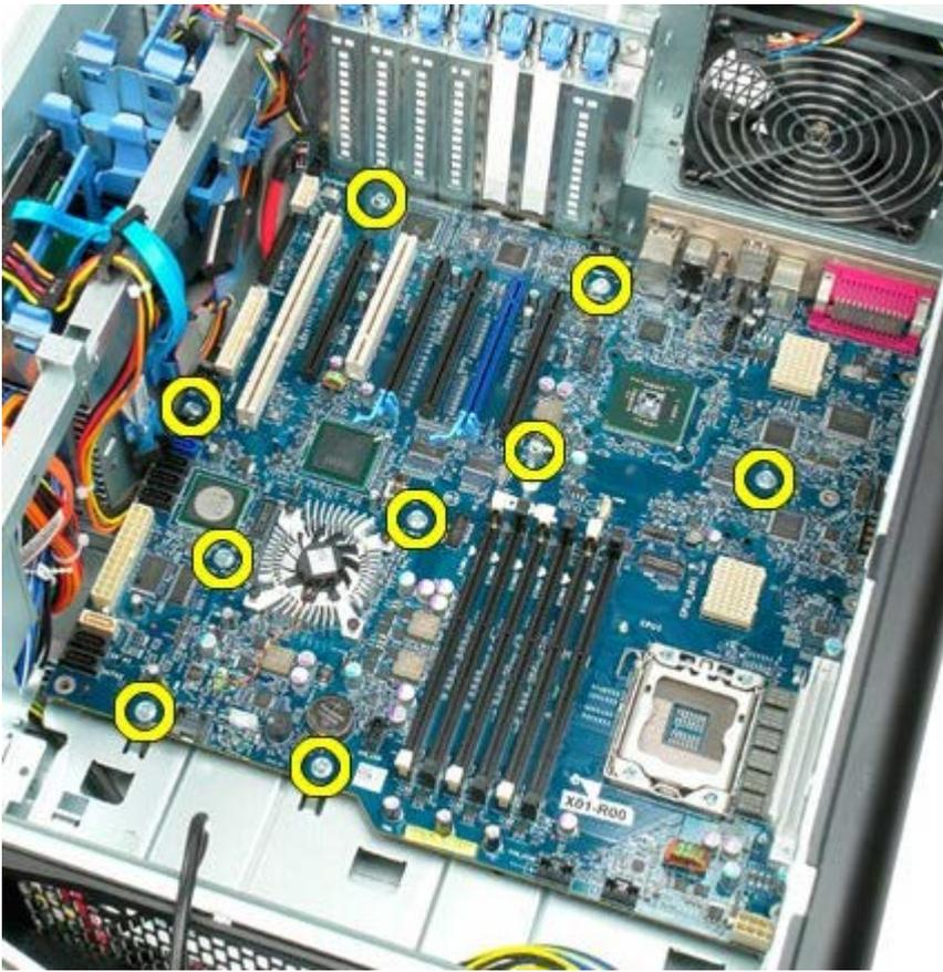
20. Deslice la placa base hacia la parte frontal del equipo.
