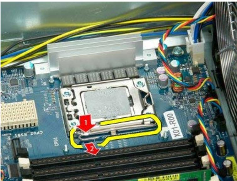
7. Levante la cubierta del procesador.
