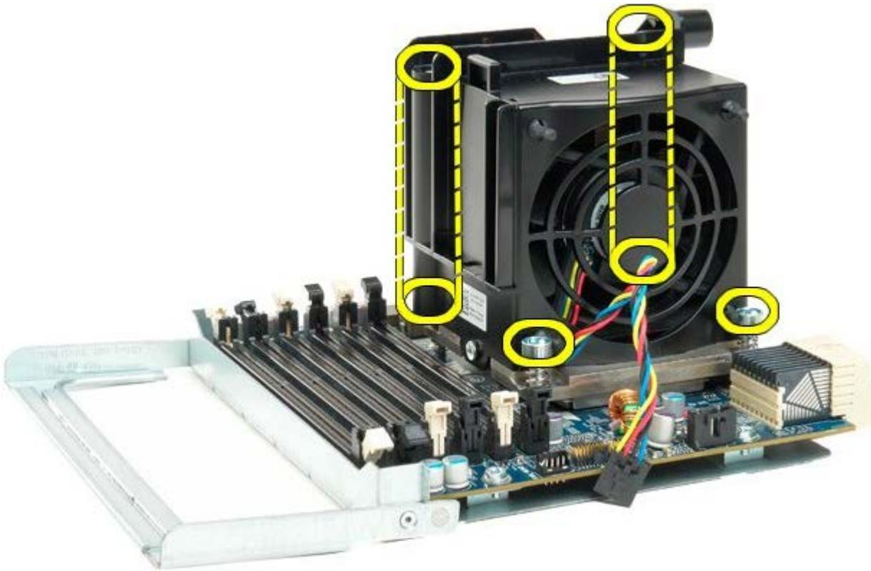
13. Extraiga el conjunto de ventilador/disipador de calor del procesador doble.
