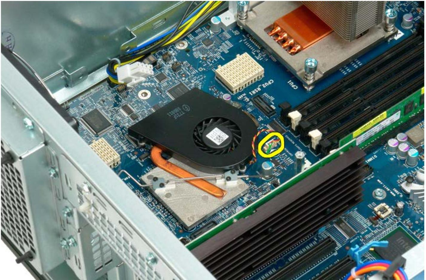
5. Suelte el gancho de retención de metal de la placa base en un extremo.
