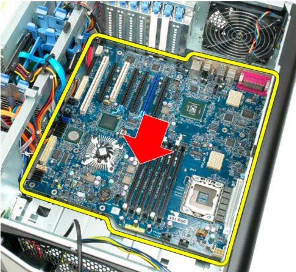
21. Levante la placa base inclinándola hacia la parte inferior del equipo.
