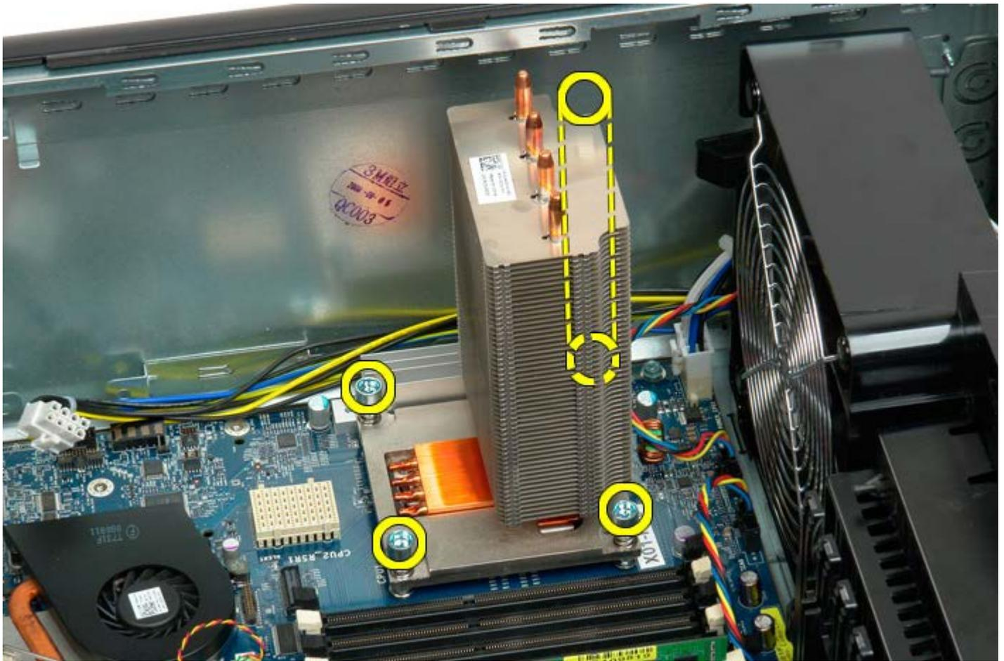
5. Extraiga el disipador de calor del equipo.
